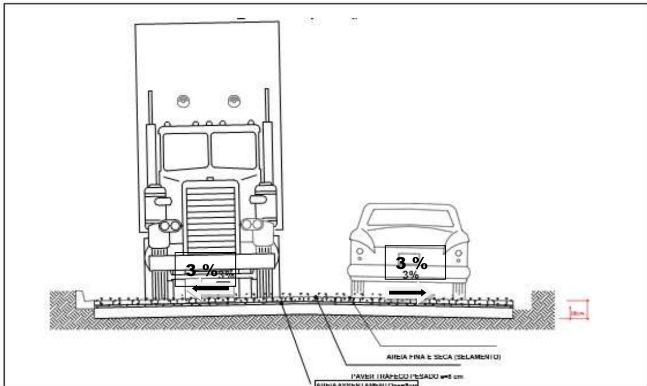
Para receber o calçamento o greide deverá ser regularizado com caimento estipulado em projeto de 3% do centro da rua em direção ao meio-fio. - Colchão de areia - consiste no espalhamento de uma camada de areia sobre base ou sub-base existente, suas principais funções são permitir um adequado nivelamento do pavimento que será executado e distribuir uniformemente os esforços transmitidos à camada subjacente.
