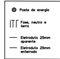
OBS: Onde não houver indicação de área, considera-se cabos de 1,5mm<sup>2</sup> e eletrodutos de 20mm
